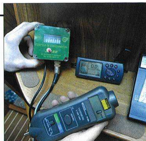
▲ Tachymètre à visée laser, débitmètre digital, sonomètre et GPS : rien n'a été laissé au hasard.
